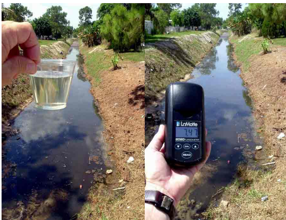
Claridad: El valor del NTU actual del agua de descarga fue de 7.5 NTU aproximadamente. La Claridad y el color del agua hablan por sí solas.
